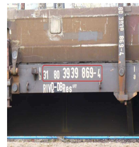
UIC Waggonnummer an einem Rungenwagen
